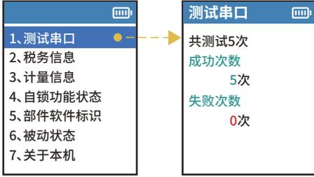
进入测试串口界面,对加油机数据通信接口(报税口)进行5次测试,并实时显示测试结果,如图所示;
