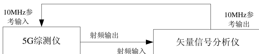
图 5 数字调制质量校准连接示意图
