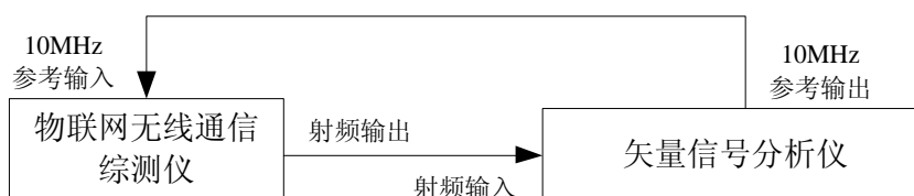
图 5 数字调制质量校准连接示意图
