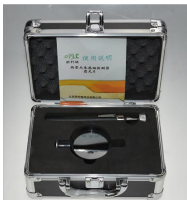
图 1 线型光束感烟探测器滤(减)光片实物图
